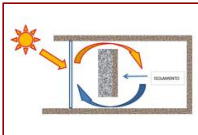
▲ Figura 2 - Muro ad accumulazione isolato
